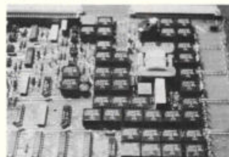
Afb. 2. SM-relais in de microprocessor gestuurde testapparatuur voor telefooncentrales UCS (universal call simulator).
